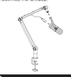
注意: BY-DM500 是动圈麦克风, 无需 48V 幻象电源供电。
